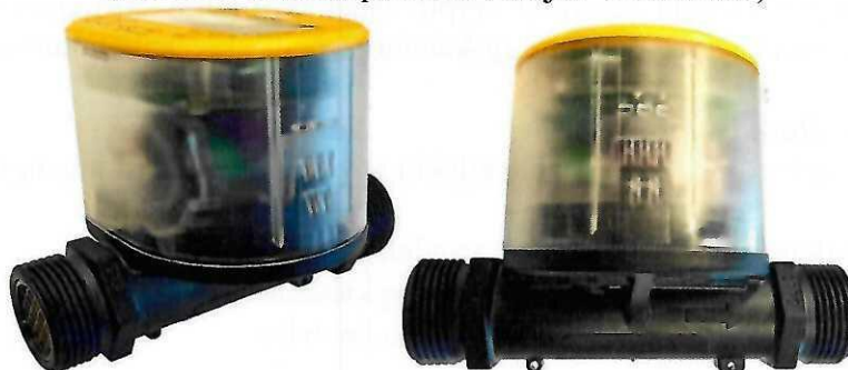
2 pav. Vandens skaitiklis QALCOSONIC W1, Q_3 = 1,6/2,5/4,0 \text{ m}^3/\text{h} , su srieginiu prijungimu G ¾ arba G 1 (skaitiklio dizainas versijos „n“ – B dizainas)
